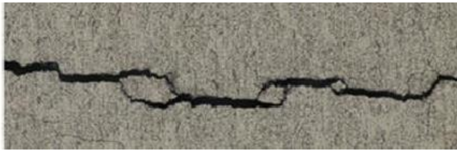
Трещины из нержавеющей стали (300x)
