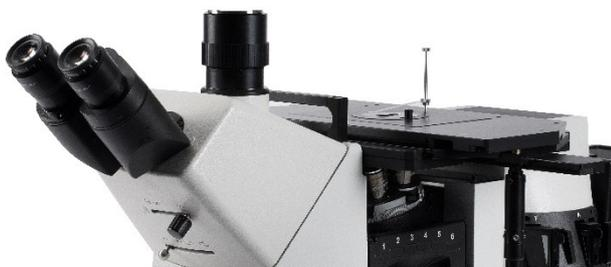
**(2) Смотровая головка с наклоном под углом 45°.**
