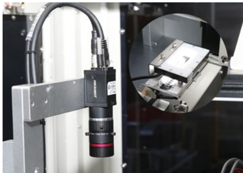
Верхняя камера контроля лицевой стороны
