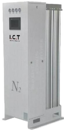
Модульный газогенератор азота использует технологию PSA (адсорбция с переменным давлением) и воздух в качестве сырья. I.C.T-SBM оснащен качественным адсорбентом, который при определенном давлении поглощает кислород, но не азот. Программируемое управление пневматическими клапанами контролирует циклы адсорбции под давлением и вакуумной десорбции, что обеспечивает полное разделение кислорода и азота, позволяя получать азот высокой чистоты.
