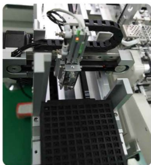
Узел точечной маркировки в лотке
