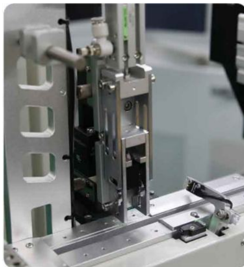
Узел точечной маркировки в ленте
