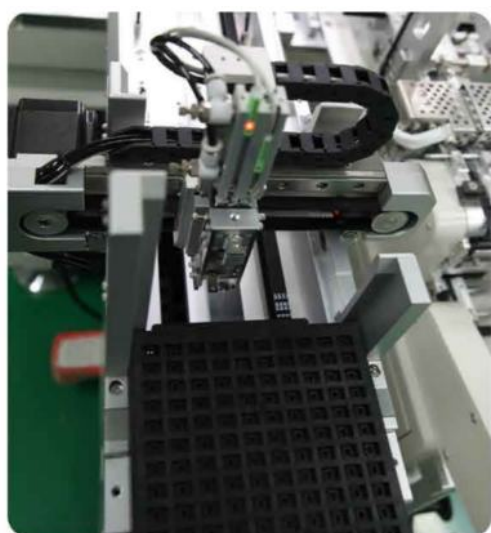
Узел точечной маркировки в лотке
