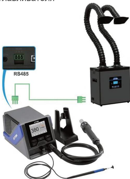
GT-1028 может управлять процессом включения и выключения дымоулавливателя.
