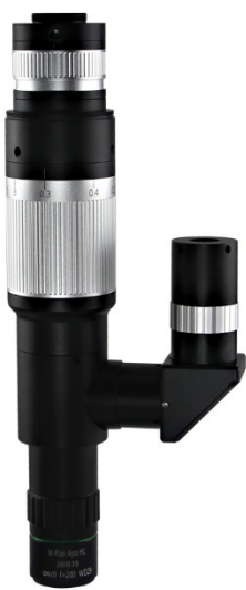
BS-1085A с коаксиальным осветителем L-типа
