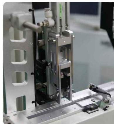
Узел точечной маркировки в ленте
