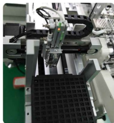
Узел точечной маркировки в лотке
