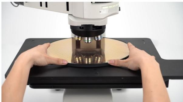
С помощью этого микроскопа можно наблюдать 12-дюймовые пластины и пластины меньшего размера, а ручка столика с быстрым и точным перемещением может значительно повысить эффективность работы.
