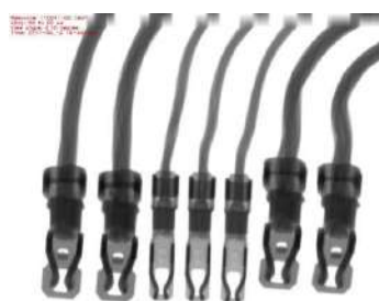
Инспекция контактов и пайки
